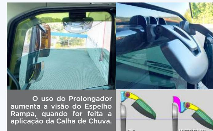
O uso do Prolongador aumenta a visão do Espelho Rampa, quando for feita a aplicação da Calha de Chuva.
